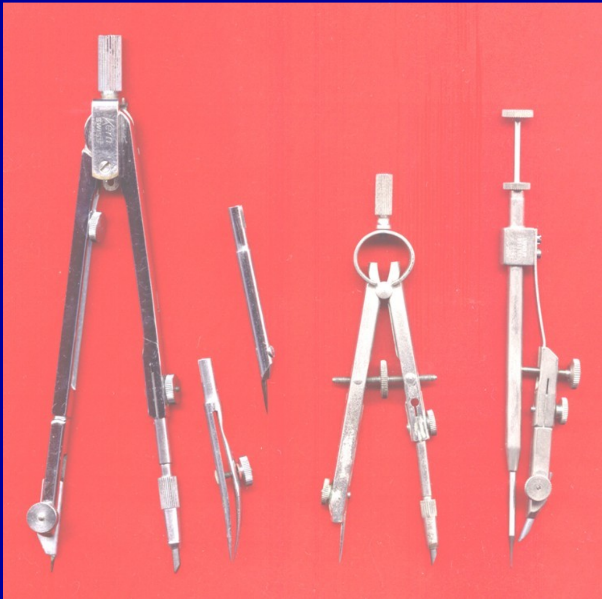
Compases (de izquierda a derecha): El Compás Trazador de piezas intercambiables, que admite elementos como el porta lápiz, porta aguja, tiralíneas y alargadera; Bigotera pequeña con tornillo de precisión y Compás Bailarina o de bomba.
